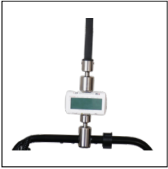
Weegschaal Klasse III (nauwkeurigheid 100 g)
